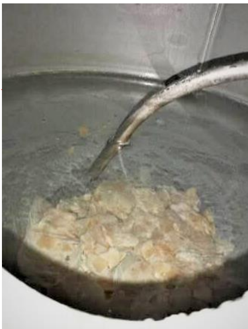
6.1.1 Retirer le tartre pr  sent dans la cuve
